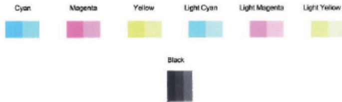
图 9-2 包含缺陷的色块示例
