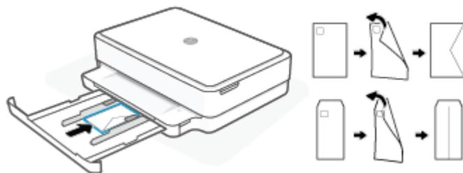
4. 将纸张宽度导轨滑动至整叠信封的左边缘和右边缘，直至在两侧边缘处不能移动为止。
