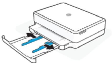
3. 将一叠全尺寸纸或照片纸插入纸盒的中央，使短边朝向打印机。对于照片纸，请确保将打印面朝下。滑入整叠纸张，直至不能移动为止。
