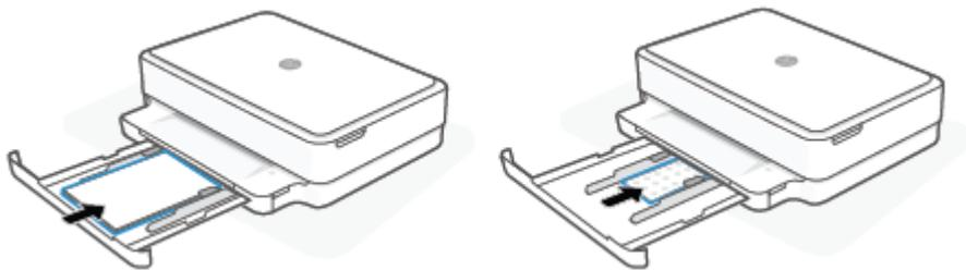
4. 将纸张宽度导轨滑动至全尺寸纸或照片纸的左边缘和右边缘，直至在两侧边缘处不能移动为止。
